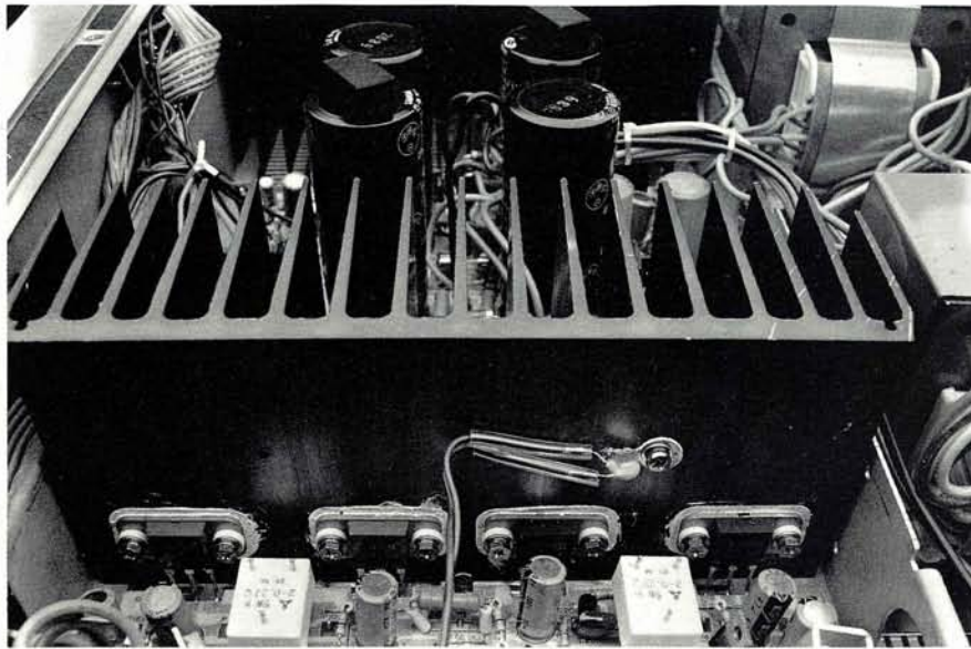
In primo piano i Mosfet J 99 (Mosfet a canale P) e K 343 (Mosfet a canale N). Lo strano componente giallo (vedi foto nella pagina precedente) fissato sull'aletta è il disgiuntore termico per la protezione contro l'eccessiva temperatura prodotta dai Mosfet.
